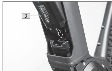
2. Inserire la batteria ricaricabile (3) con il fissaggio nel supporto inferiore del telaio. Assicurarsi che il fissaggio sia inserito correttamente nel supporto del telaio.
